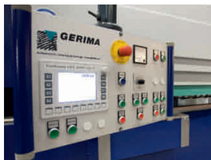
Die Bandschleifanlagen der LG-Serie von Alme-Gerima werden direkt über das Bediengerät auf dem Steuerpult parametrierbar.
